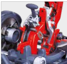
Automatická řezací hlava s integrovaným promazáváním olejem
